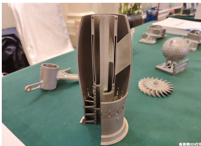
飞而康 3D 打印的经过了结构优化的金属件
