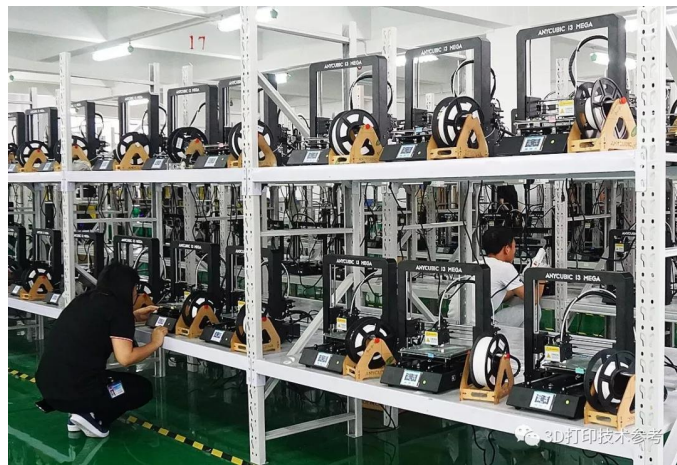
中国某品牌 FDM 打印机调试车间
